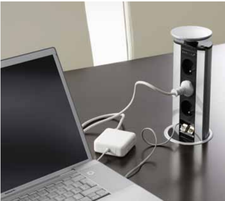
Der EVOLINE-Port wird als ein Auszugssystem in die Tischplatten integriert und tritt in vielen Systemkombinationen auf (unterschiedliche Anzahl von Strom-, Medien- und Internetanschlüssen). Der auf dem Bild dargestellte EVOLINE-Port hat drei 230-v-Anschlüsse und zwei Anschlüsse RJ45 für den Internetzugang.
